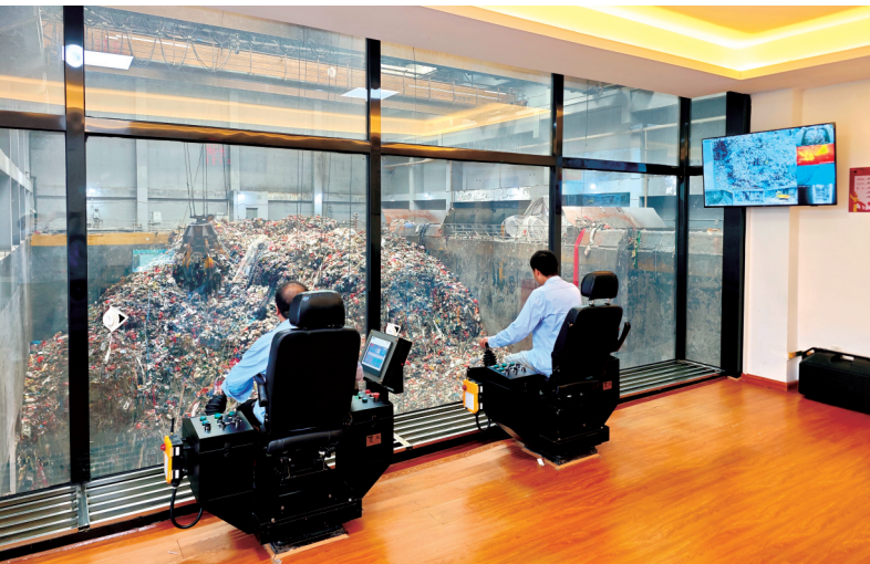
垃圾吊控室内,操作员操控抓斗,将垃圾抓进料斗。 邵阳日报记者 石周鑫 摄
