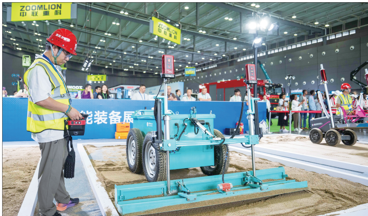
6月25日,2026长沙国际绿色智能建造与建筑工业化博览会(简称“筑博会”)在长沙国际会展中心开幕,本届展会以“科技赋能智能建造·创新引领美好生活”为主题,展览总面积达4.5万平方米,吸引了建筑行业近千家全产业链企业参展。图为6月25日,在长沙国际会展中心,技术人员操作混凝土整平机器人进行地面整平演示。 新华社记者 陈思汗 摄
