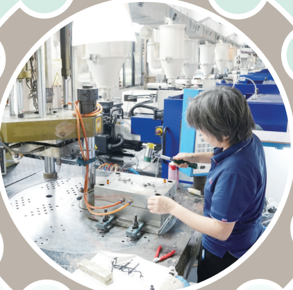
铭瑞智能家居扫地机器人耗材的注塑车间。
